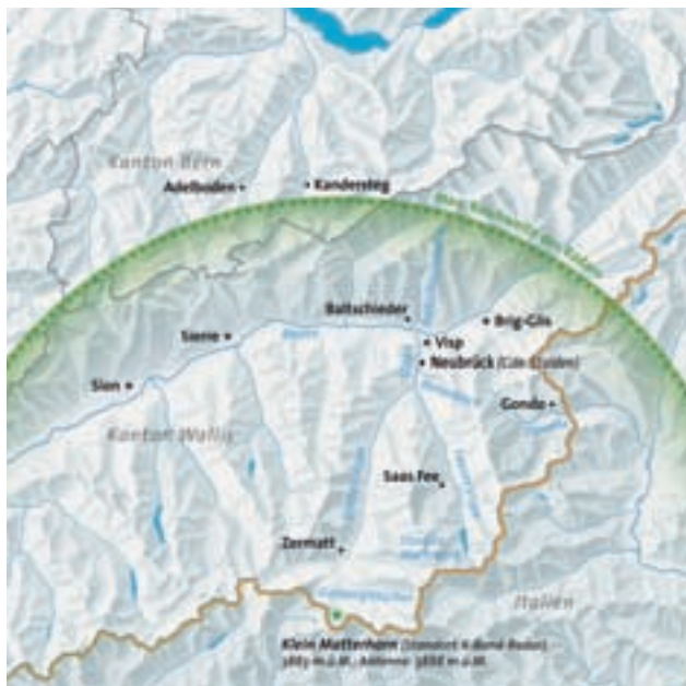
Das Regenradar der Forschungsgruppe von Paolo Burlando auf dem Klein Matterhorn auf 3883 Metern über Meer deckt grosse Teile des Oberwallis ab, Einzugsgebiet jener Gewässer, die im Jahr 2000 die grössten Schäden angerichtet haben.
