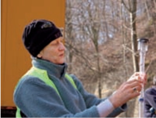
Nach künstlicher Beregnung: Versuchsleiterin Sarah Springman misst die Saugspannung im Boden mit dem Tensiometer. Der Rutschversuch in Rüdlingen ist geglückt. Ein Auffangnetz sammelt die Erdmassen.
